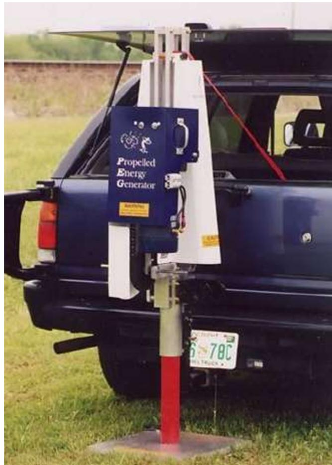
I generatori PEG costituiscono fonti di energia sismica portatili, caratterizzati da un peso contenuto. I sistemi PEG utilizzano una tecnologia “elastomer band” semplice ed efficace che viene utilizzata per spingere il martello ad una velocità elevata.
