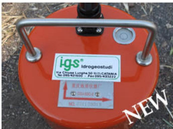
Questo geofono 3D è dotato al suo interno di 3 sensori (velocimetri) che rilevano contemporaneamente i segnali sismici da tre direzioni ortogonali e li trasformano in impulsi elettrici.
